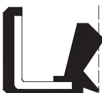
Ls Doble Labio sin Resorte Double Lip without Spring
