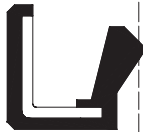
Li Simple Labio sin Resorte Simple Lip without Spring
