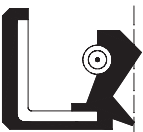
Lx Doble Labio con un Resorte Double Lip with one Spring
