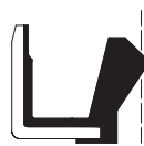
Mi Simple Labio sin Resorte Simple Lip without Spring
