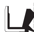
Ms Doble Labio sin Resorte Double Lip without Spring
