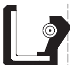
Lz Simple Labio con Resorte Simple Lip with Spring
