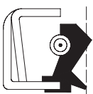
Kx Doble Labio con un Resorte Double Lip with one Spring
